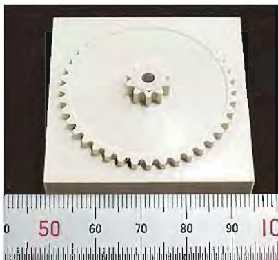
工件尺寸：长45×宽45×高度20 (mm) Work size: 45×45×20mm (形状高度：6.5mm) Profile height
